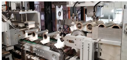
芯板钎焊前钣金加工流水线，每条线年产80万m<sup>2</sup>，采用智能制造，每班3人巡视
