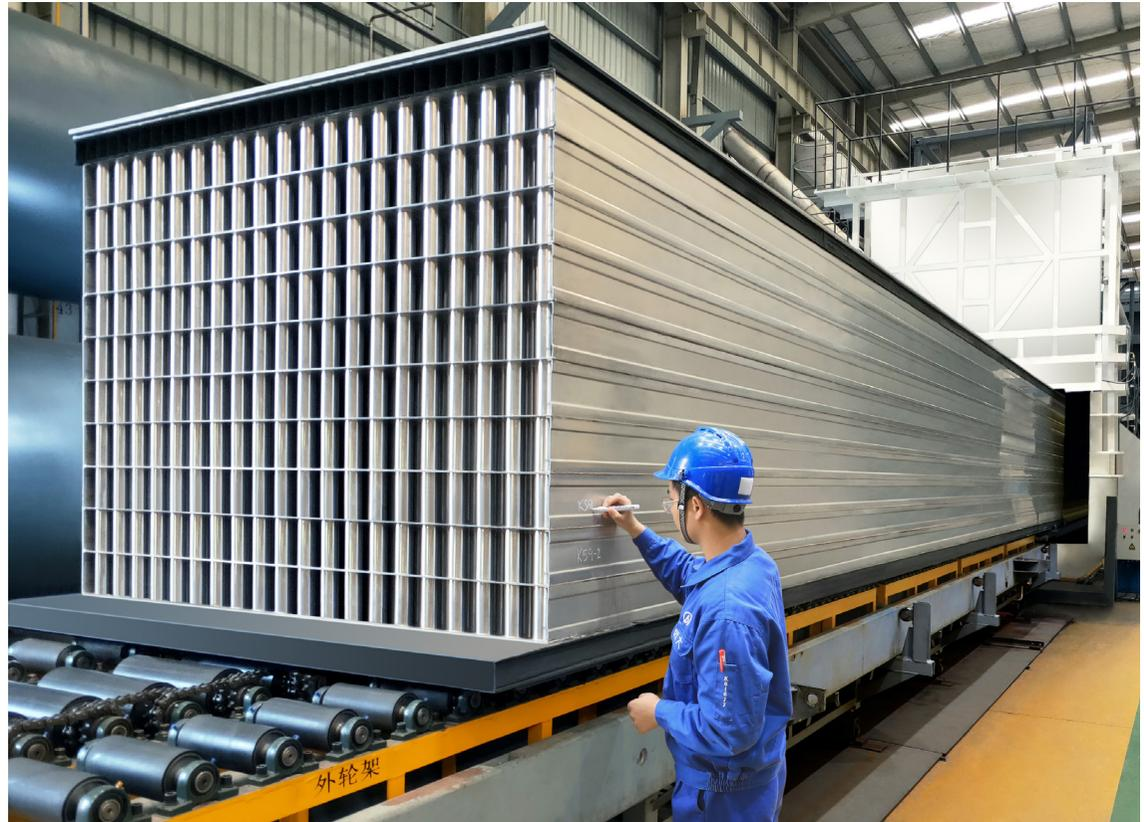
远大芯板钎焊工艺：上下两块钢板，中间夹非常薄的芯管阵列，芯管端垫铜箔，经1100°C热风钎焊而成
